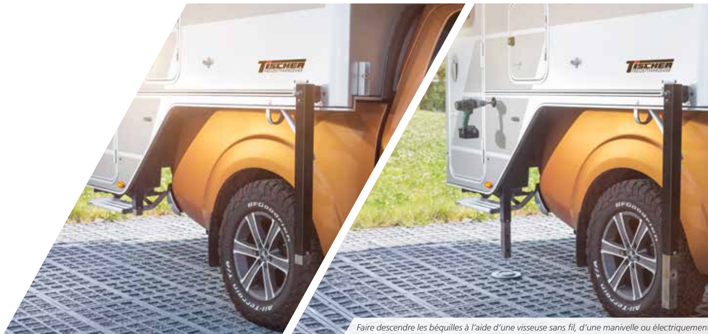
Faire descendre les béquilles à l'aide d'une visseuse sans fil, d'une manivelle ou électriquement
